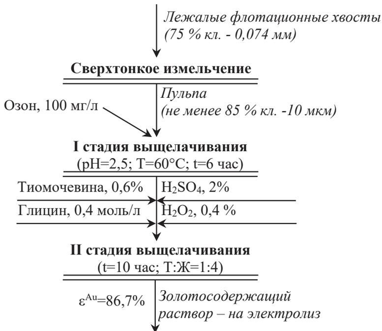
Рисунок 3. – Технологическая схема тиокарбамидного выщелачивания золота из лежалых сульфидных флотационных хвостов
