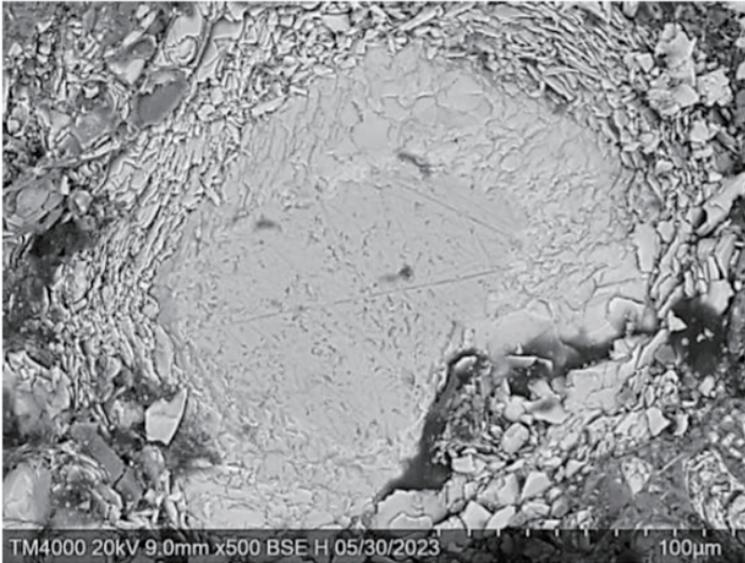
Рисунок 4 – СЭМ изображение фрагмента 2 рисунок 1. Кальций содержащее ядро (темно серое) и многослойная «скорлупа», содержащая стронций.
