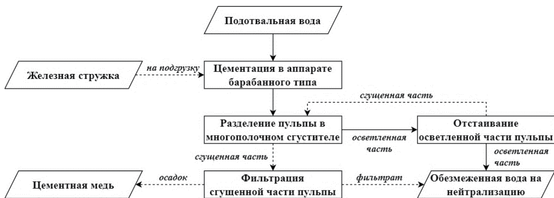
Рисунок 1 – Технология цементационного извлечения меди из подотвальных вод, разработанная для АО «Святогор»
