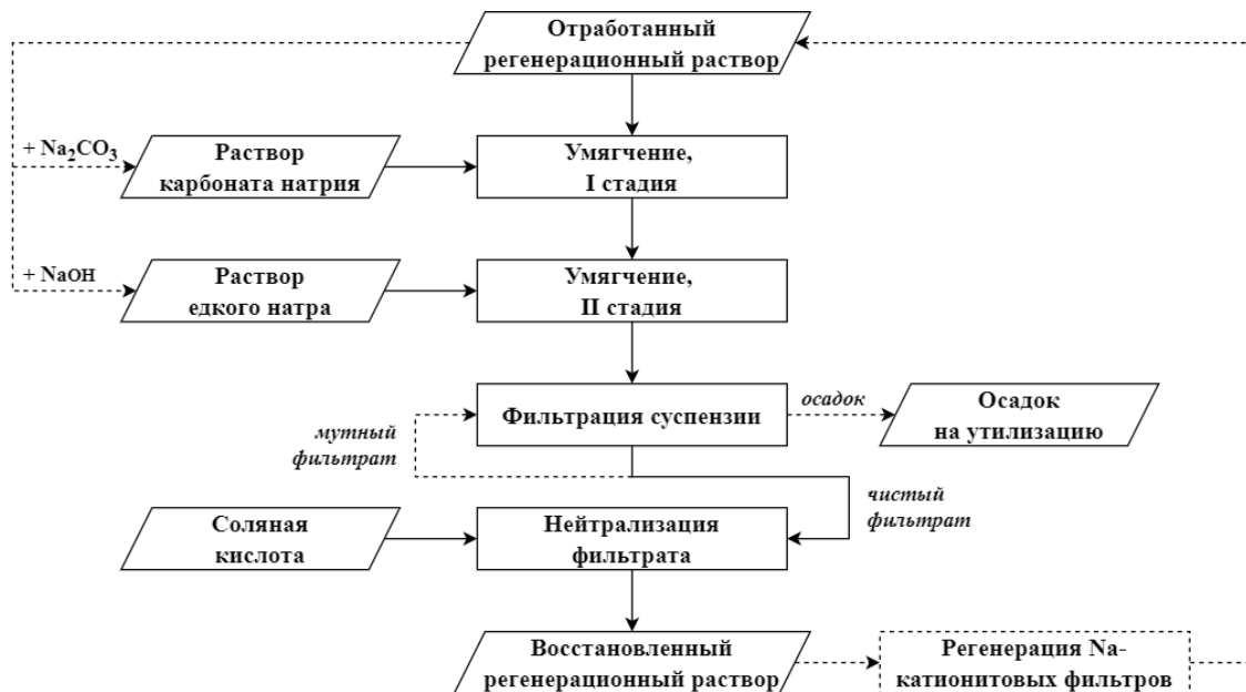
Рисунок 9 – Технология рециклинга элюатов от регенерации Na-катионитовых фильтров, разработанная для филиала «ППМ» АО «Уралэлектромедь»
