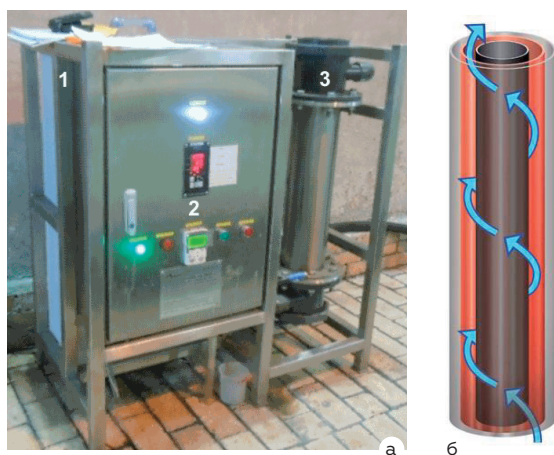
Рисунок 1 – Установка вихревого электролиза: а – общий вид (1 – резервуар для электролита, V = 100 \text{ дм}^3 ; 2 – электролизная ячейка; 3 – шкаф управления), б – направление потока электролита в электролизной ячейке
