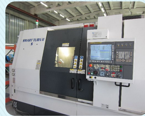
Токарно-фрезерный обрабатывающий центр Biglia Smart Turn 1200S
