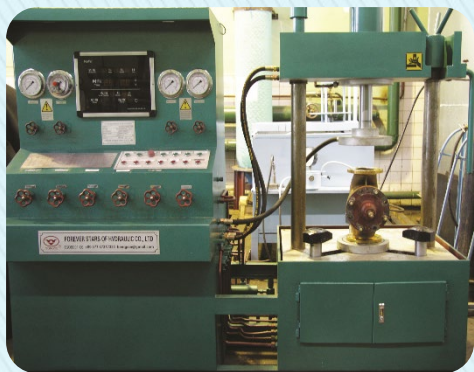
Стенд для гидравлических испытаний
