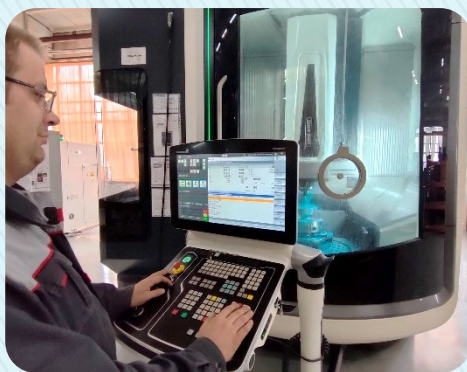
Фрезерный обрабатывающий центр с ЧПУ модели DMU 85 monoBLOCK
