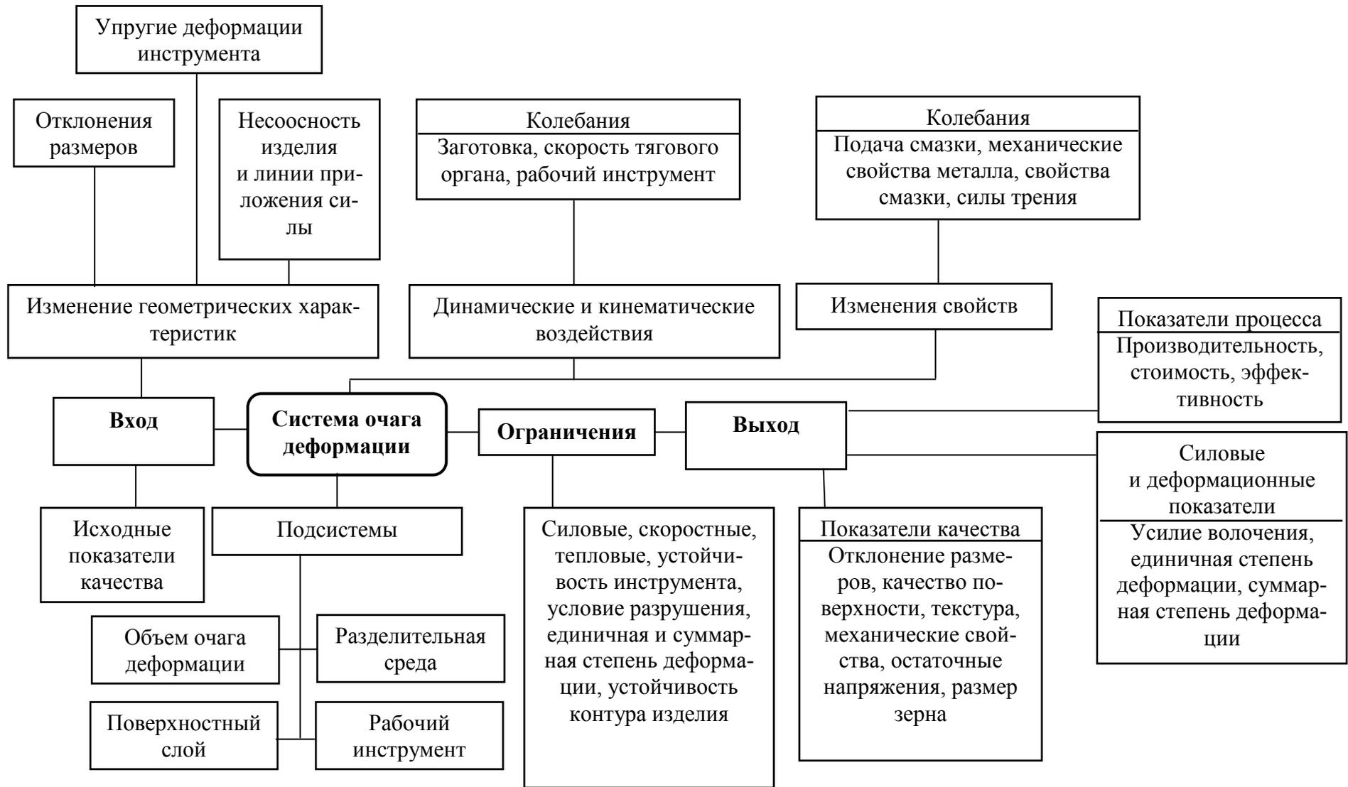
Рис. 1.7. Структура системы очага деформации и системные объекты
