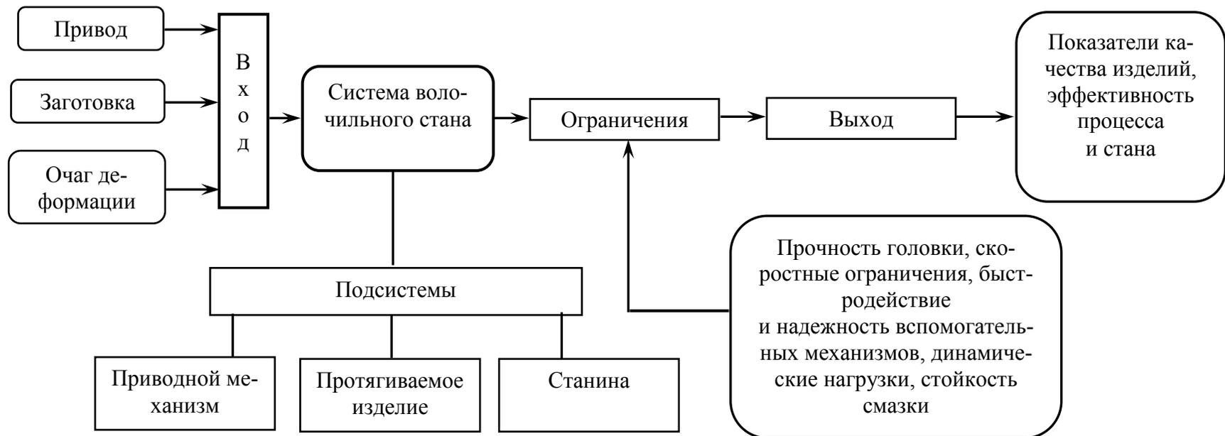
Рис. 1.6. Структура системы волочильного стана и системные объекты
