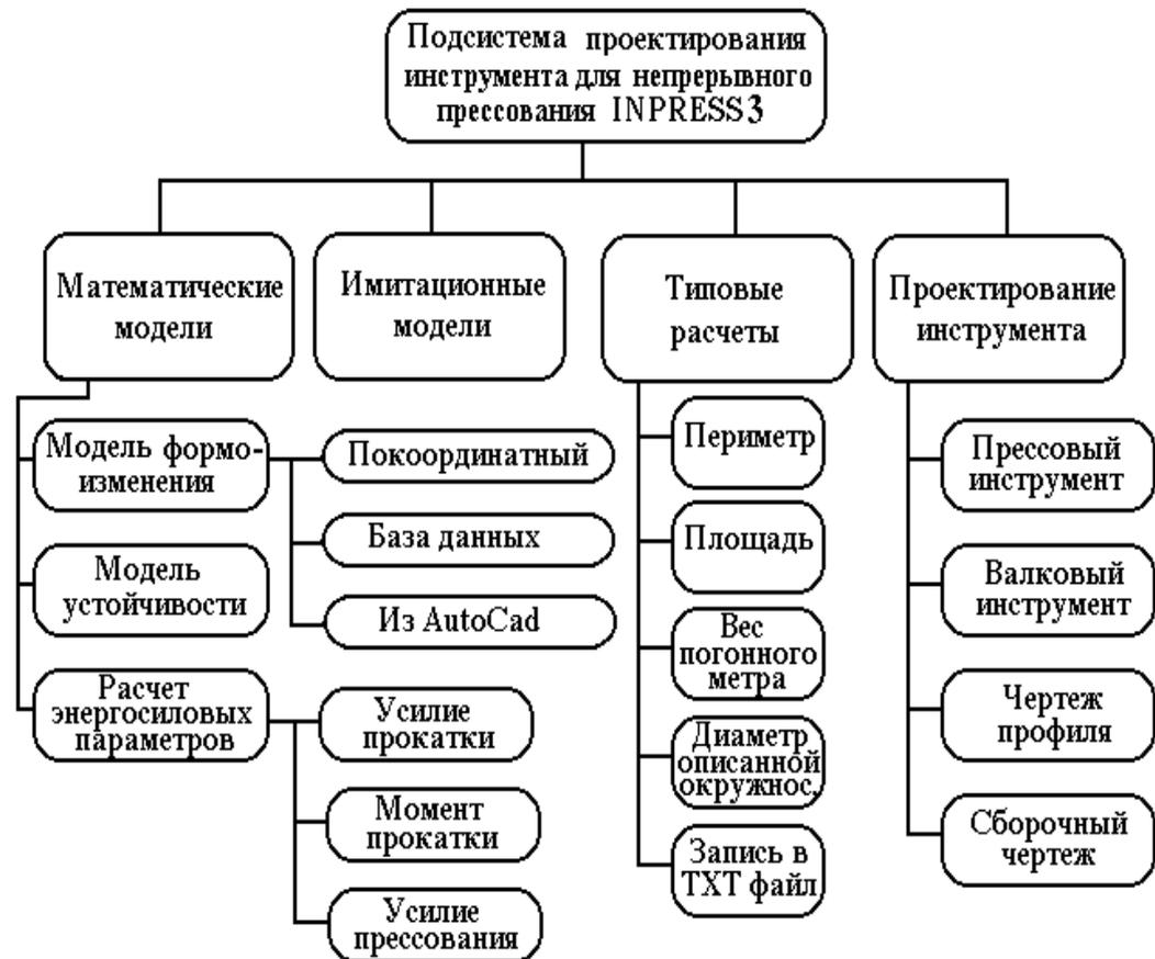
Рис. 6.6. Структурная схема подсистемы
