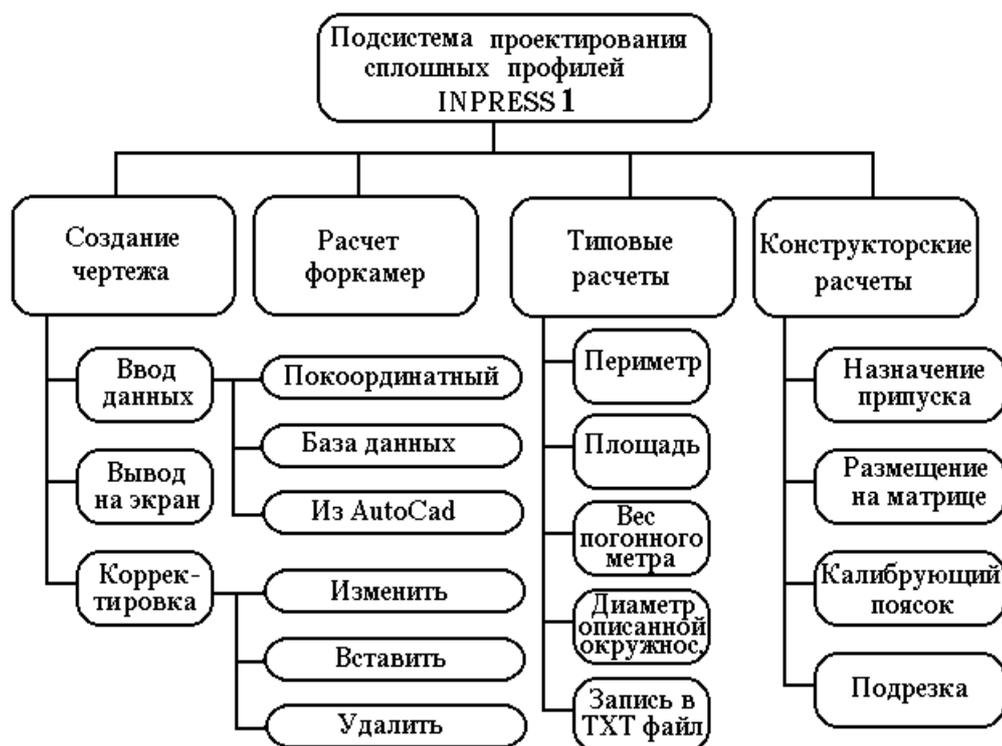
Рис. 6.2. Структурная схема подсистемы INPRESS1
