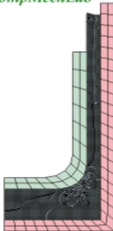
Конечно-элементная модель. Адаптивное перестроение КЭ сетки. Деформированное состояние
