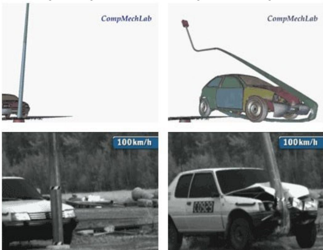
Моделирование краш-теста в LS-DYNA. Сравнение с экспериментом
