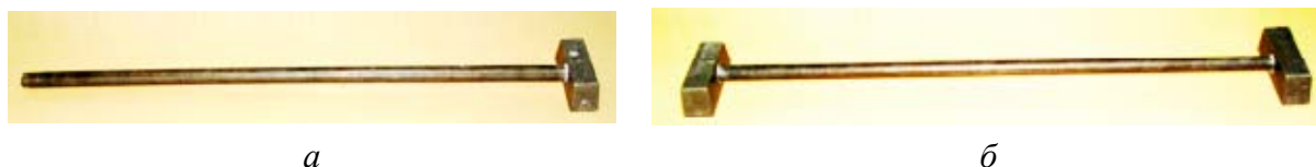
Рис. 4. Модели для определения свободной (а) и затрудненной (б) усадки
